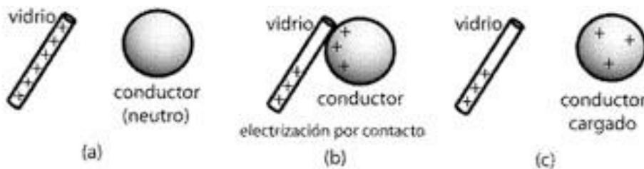
(a) Varilla de vidrio cargada positivamente y conductor neutro (antes del contacto); (b) La varilla de vidrio toca al conductor y lo carga positivamente al extraer de él algunos electrones; (c) Al separarlos nuevamente, la varilla de vidrio sigue cargada positivamente pero con una carga menor que antes del contacto, y el conductor (que inicialmente era neutro) queda cargado positivamente.
